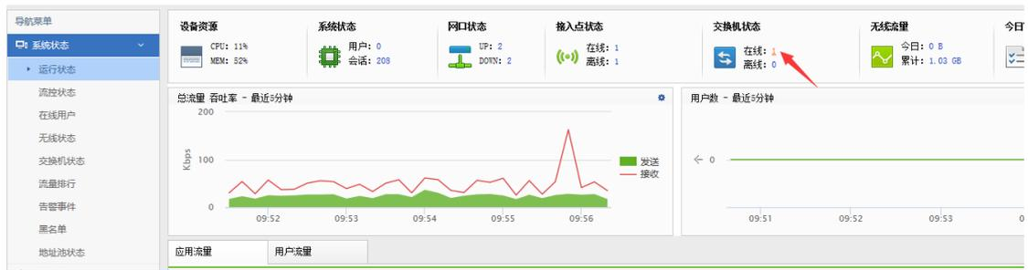
在【系统状态】-【交换机状态】的交换里可查看端口状态
