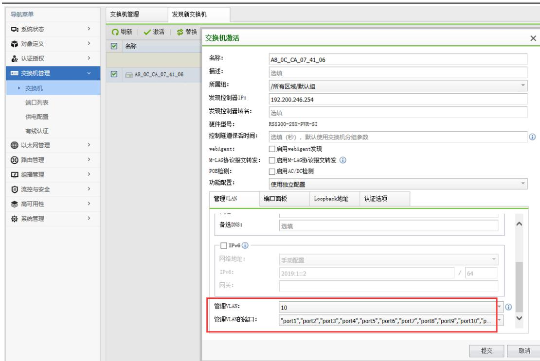
3、在端口面板里面选择上联口，编辑 VLAN 属性，VLAN 属性一般设置模式和上层设备一致，VLAN 设置和管理 VLAN 一致。设置无误，点击提交，激活交换机。
