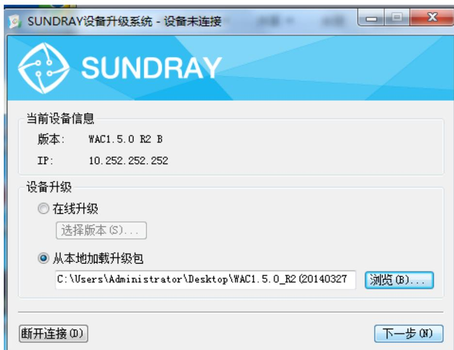
『当前设备信息』：用于显示连接的 SUNDRAY 设备的版本信息以及连接的 IP 地址。
