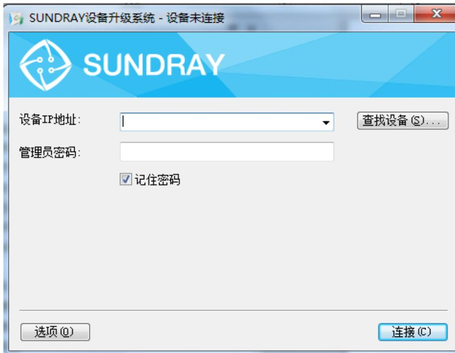
『设备 IP 地址』：连接的 SUNDRAY 设备的 IP 地址，格式为 IP: 端口，也可以直接输入 IP 地址进行访问，则默认连接的是该 IP 地址的 51111 端口。
