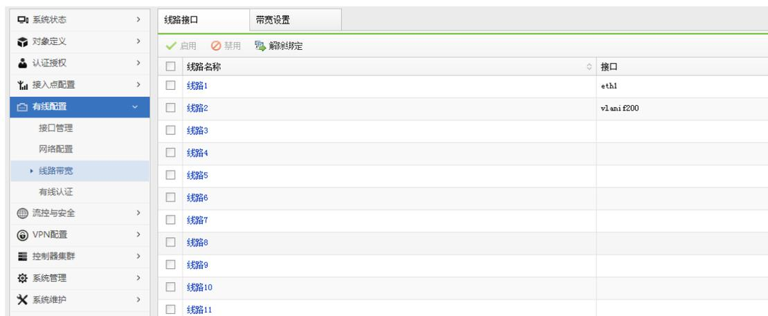
设备在正常转发数据的时候，数据会从一个接口进，从另外一个接口出，在这个接口上配置了线路，经过这个线路的数据才能被流控，最多支持 16 条线路(设备型号不同支持最大线路数不同)。在配置线路的时候，接口类型可以有多种选择：物理口、三层 vlanif 口、二层聚合口，可以根据不同的组网需要选择不同类型的接口。在选择接口的实时时候需要遵循以下几个原则：
